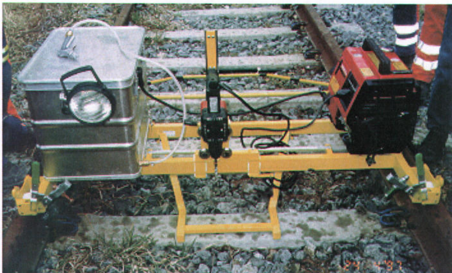
Figur 27 Borejigg med alt utstyr
