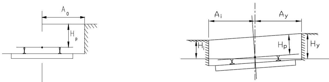
Figur 14.1 Plattformhøyder og avstand spormidt - plattformkant
