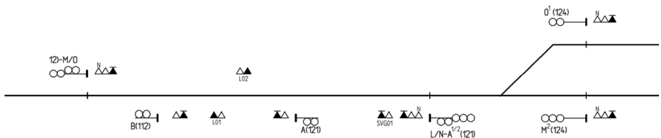
Figur 4.5 Utsnitt av Signal- og baliseplassering for enkeltspor
