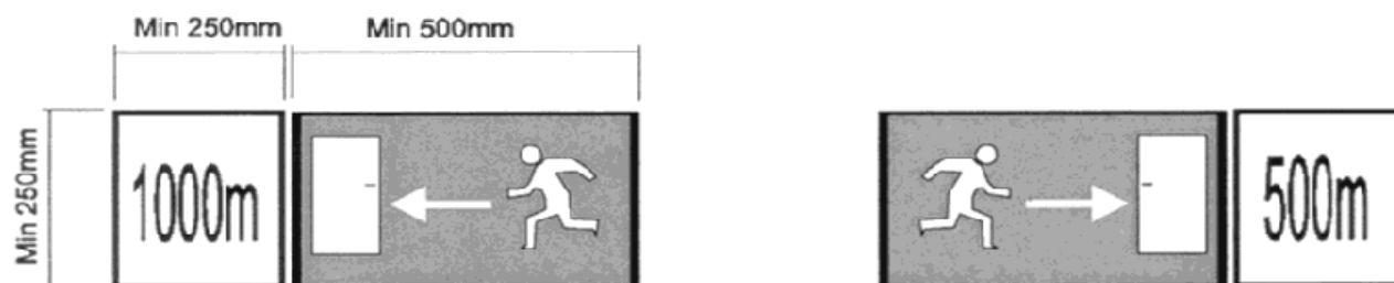
Figur 12.7 Eksempel på utforming av anvisningsskilt
