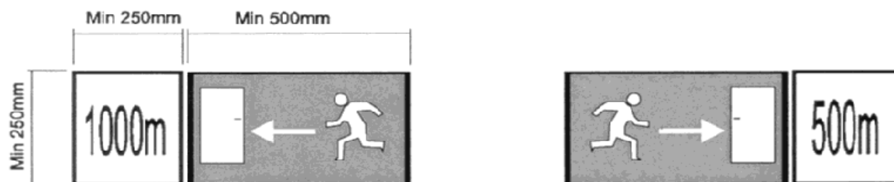
Figur 12.7 Eksempel på utforming av anvisningsskilt
