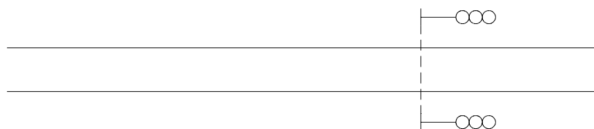
Figur 6.13 Plassering av innkjørhovedsignaler på dobbeltsporet bane.
