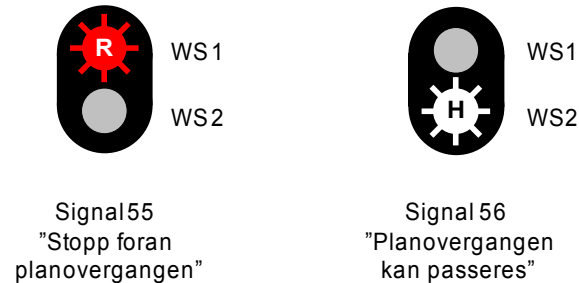
Figur .15 Planovergangssignal - signalbilder
