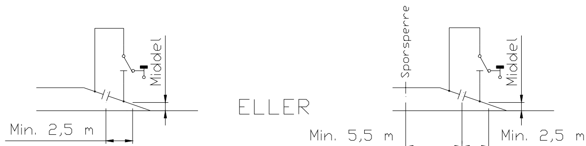
Figur 6.2 Arrangement ved lastespor, sidespor og hensettelsesspor.
