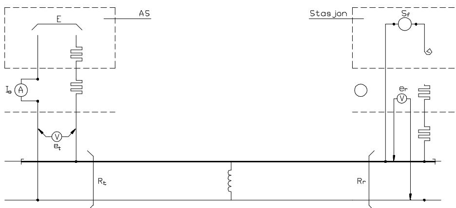
Figur 6.d.2 Veiledende kretsskjema for måling av ballastmotstand.
