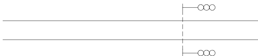
Figur 6.13 Plassering av innkjørhovedsignaler på dobbeltsporet bane.
