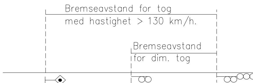
Figur 6.2 Utførelse av signalering etter krav til plassering.
