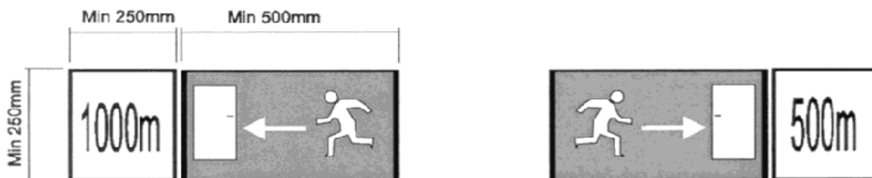
Figur 12.7 Eksempel på utforming av anvisningsskilt
