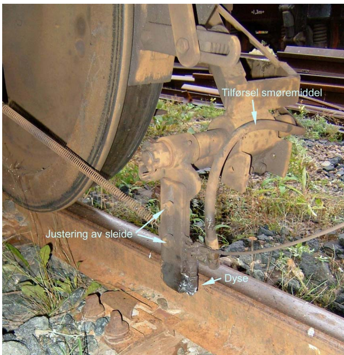
Figur 6-2 BaneService sin smørevogn. Detalj fra påføringsanordning. Foto: Geir Rør.
