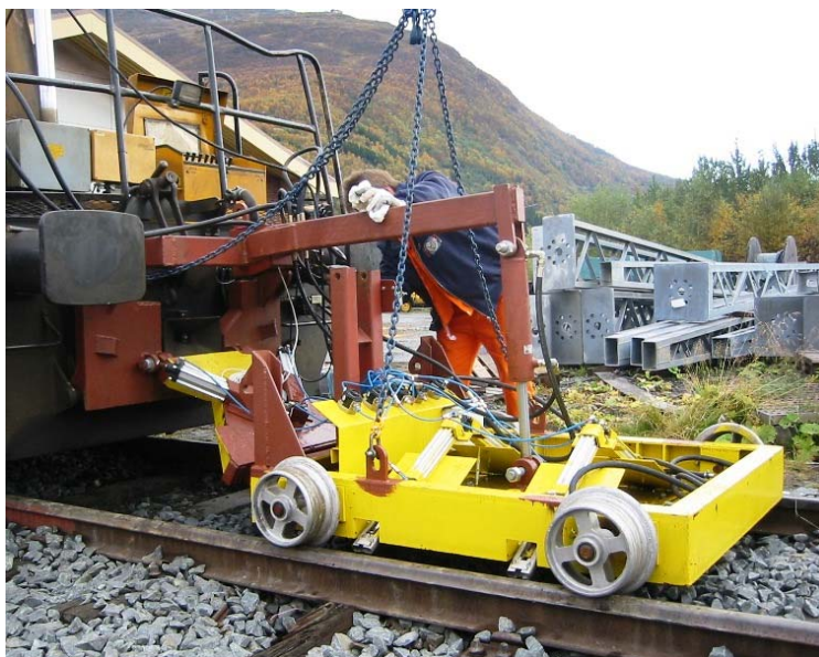
Figur 6-4 Smøretralle på Ofotbanen. Foto: Alf Helge Løhren.
