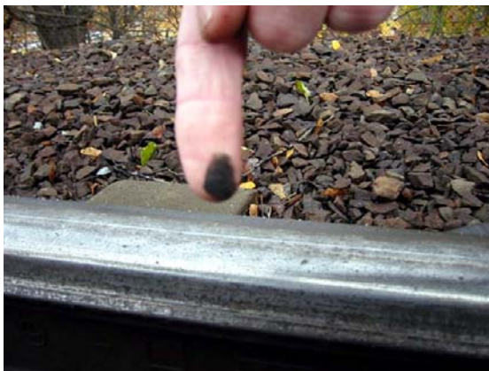
Figur 10-2 Fingerkontroll av smøring på skinne
